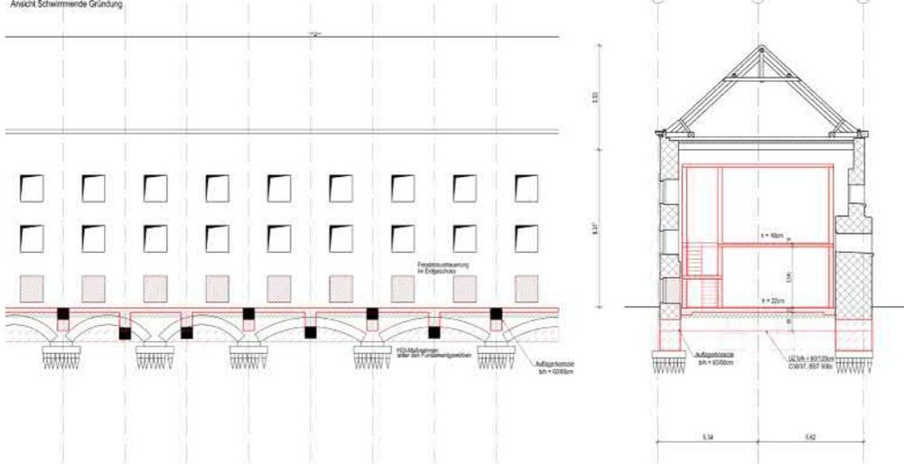
Längsschnitt / Querschnitt der Schwimmenden Gründung des Magazingebäudes
